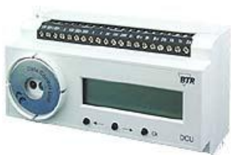
Abbildung 11: Datenlogger der BTR NETCOM GmbH
