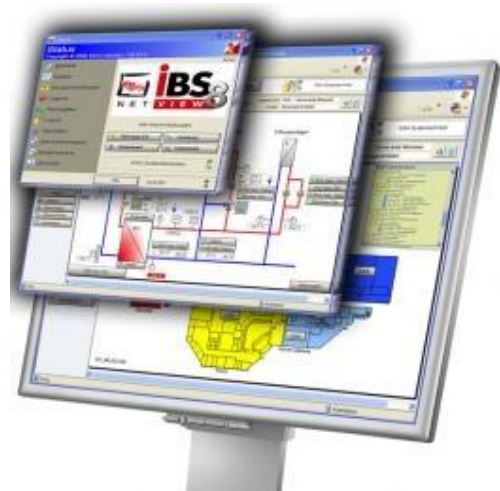
Abbildung 14: Gebäudeübergreifendes Leittechniksystem System „IBS“ der INGA mbH
