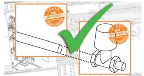
Abb. 4: Beim alternativen SOLAR-COMPUTER-Konzept arbeitet der Planer mit Original-Autodesk- oder BIM-zertifizierten Revit-Familien. Zeichnen und Berechnen sind automatisch verknüpft. Zum Berechnen werden nur die technischen VDI 3805-Daten benutzt.
