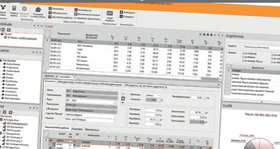
**Modular aufgebautes Paket zum Planen von Heizungsanlagen aller Art. Heizlast nach DIN EN 12831-1, dynamisch nach VDI 6020 sowie zur TW-Erwärmung nach DIN EN 12831-3. Berechnen von Heizkörpern, Flächenheizungen und kombinierten Systemen. Heizungs-Rohrnetzberechnung inkl. Schema-Editor. Verarbeiten neutraler und/oder fabrikatbezogener TGA-Objektdaten. Schnittstellen zum Integrieren in CAD oder BIM-Arbeitsprozesse.**
