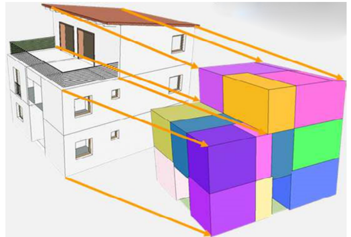
Abb. 21 3D-Ansicht eines eingelesenen oder zeichnerisch neu erfassten Architekturmodells im „Raumtool3D“. Das Tool erkennt Räume und Bauphysik-Bauteile mit Nachbarraumbeziehungen und angepassten Abmessungen, wie sie für SOLAR-COMPUTER-Berechnungen notwendig sind.
