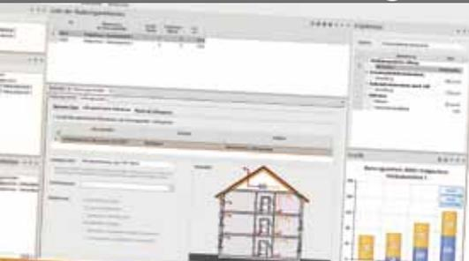
**Komfortables Berechnen Lüftungstechnischer Maßnahmen nach DIN 1946-6 unter Berücksichtigung der bauphysikalischen, hygienischen, Lüftungs- und gebäudetechnischen Eigenschaften und des Energieverbrauchs des Gebäudes. Berechnen von Luftvolumenströmen in Wohn- und Nichtwohngebäuden nach verschiedenen Normen und Richtlinien je nach Nutzungs- und Betriebsart. Schnelle und einfache Nachweise für alle Projektarten.**
