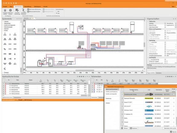
Programm zum Planen von symmetrischen und unsymmetrischen Heizungs-Rohrnetzen für Projekte vielseitiger Art und Komplexität. Schnelle und einfache Datenerfassung und Bearbeitung im 2D-Rohrnetz-Schema mit Hilfe intelligenter Funktionen für hydraulische Schaltungen. Austausch- und Kombinierbarkeit von eigenen und produktneutralen Standard-Katalogen sowie Daten aus eingelesenen 3805-Hersteller-Datensätzen.
