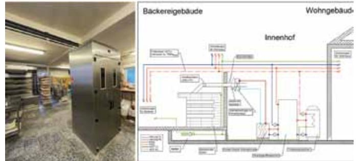
Bäckstube: Konzept mit Wärmeübertrager und WW-Wärmepumpe.
